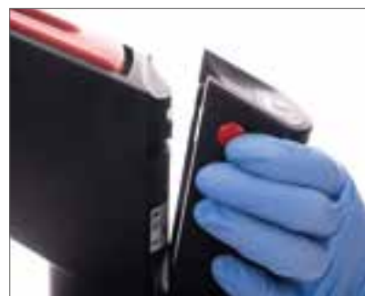
► Stisknutím obou uvolňovacích knoflíků se dá baterie snadno a rychle vyměnit. Provozní parametry se uchovávají 30 sekund.
