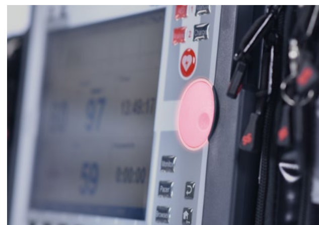
▲ Vizualizace alarmu rozsvíceným otoč. ovladačem a varovnými tóny.
