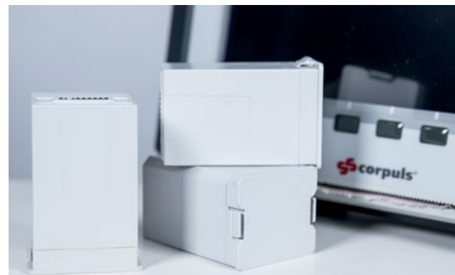
► Jednotlivé baterie systému corpuls 3 lze dle potřeby zaměňovat.
