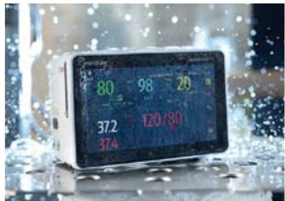
Robustní design N1 podporuje stupeň odolnosti IP44 proti prachu/vodě a ochrana proti pádu z 1,2 m pro šest povrchů eliminuje problémy při náhodném postřikání kapalinami či poškození přístroje během přepravy.
