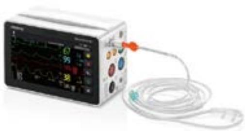
Monitor N1 má plně integrovaný modul sidestream CO<sub>2</sub>, který monitoruje stav dýchání pacienta prostřednictvím přímého spojení s linkou pro odběr vzorků. Nejsou zapotřebí žádné další moduly pro transport pacientů, obzvláště jsou-li intubovaní.
